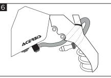
ATTENTION: fuel line assembly detail. ATTENZIONE: dettaglio montaggio tubo/pompa.
