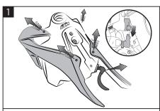
IRemove the radiator scoops. Disconnect the fuel pump cover cable and the fuel connector as indicated in the diagram. Inserire la vite nel foro della parte superiore del serbatoio.
